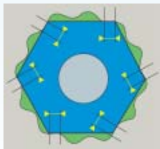
Powerdriv ® -val felületekre eloszló erőátvitel
