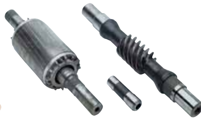
Reparação de veios de rolamentos para posterior rectificação
