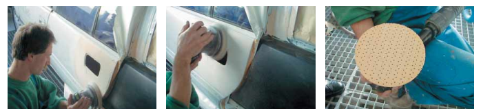
Schleifen von Spachtel mit Useit® Superpad P Kfz, Korn 100
