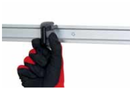
1. Linke Klemmbacke durch kippen nach links auf der Schiene arretieren.
