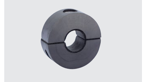
Kälterohrschelle PUR 250 TYP 175 Mit Schrauben, fest eingeschäumt in PUR-Hartschaum, an den Innenflächen mit Kautschukmantel Art.-Nr. 0874 303 ...
