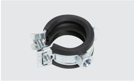
Rohrschelle TIPP®-Smartlock GS Standard-Gelenkschelle zum Aufklappen. Mit exklusivem Würth Schnellverschluss für die sichere und schnelle Montage Art.-Nr. 0543 068 ...
