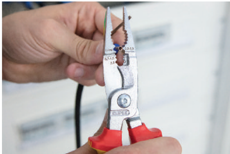
5. Matrice de sertissage pour cosses de 0,5 - 2,5 mm 2 .
