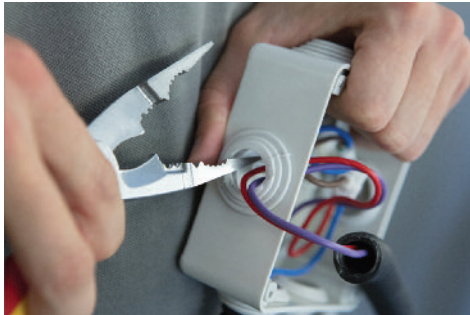
3. Bord extérieur de la mâchoire à arête plus vive pour rogner les boîtes encastrées et ébavurer les trous de traversée.
