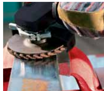
Remoção de ferrugem e alisamento de peças
